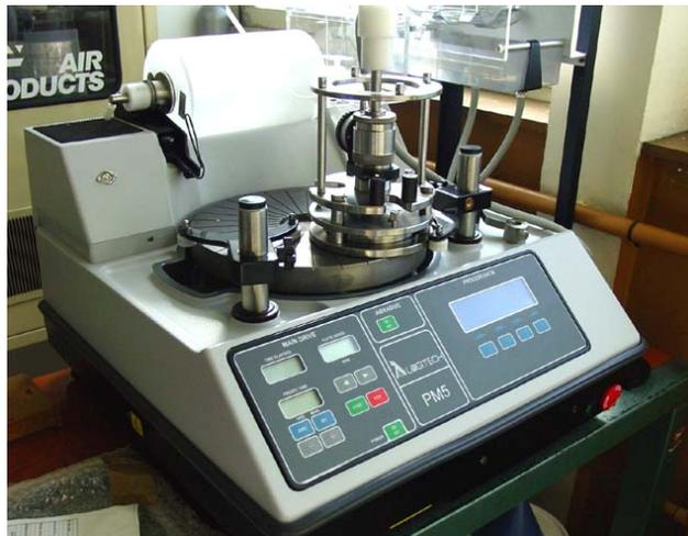
FIG. 3.30. Photographie de la polisseuse *Logitech PM5* utilisée pour l'amincissement et polissage du verre.
