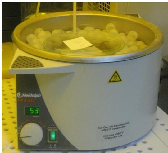
FIG. 2.15. Bain-marie utilisé pour la gravure KOH. La solution est dans un bécher plongé dans l'eau chauffée dont le niveau est toujours supérieur à celui du KOH dans le bécher, afin de maintenir la température stabilisée de la solution. L'évaporation d'eau est réduite grâce aux billes ainsi qu'au tuyau de contrôle de niveau, lié à un réservoir adjacent.
