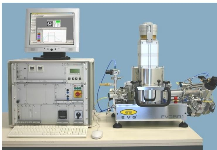
FIG. 3.28. Photographie de la machine de soudure anodique et thermocompression EVG501 [EVG2].
