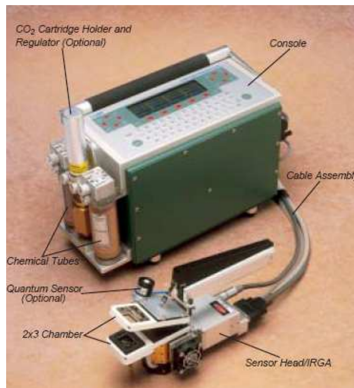
Figure 19 : Cliché de la LI-6400 avec chambre ouverte pour la mesure d'une surface foliaire de 4cm 2 (extrait du manuel d'utilisation de l'appareil 2 ).
