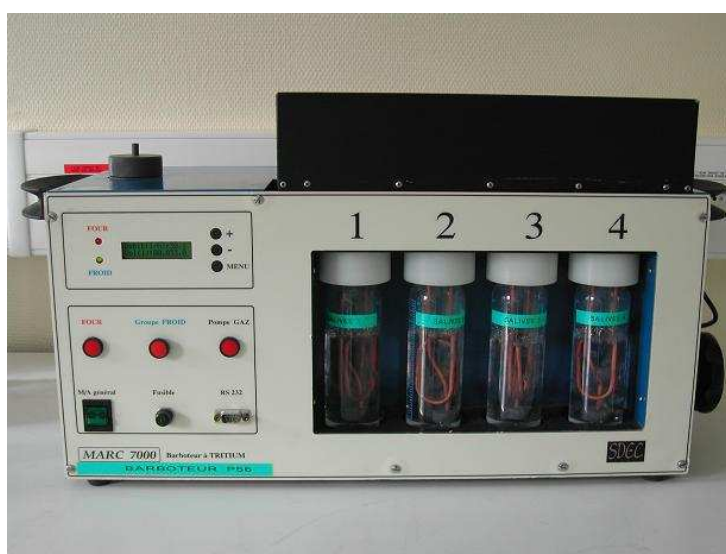
Figure 38 : Photographie d'un barboteur utilisé dans cette étude pour le piégeage du tritium atmosphérique (MARC 7000, SDEC, Reignac sur Indre, France).
