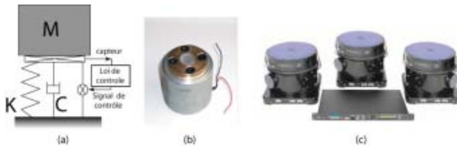
FIG. 1.11 – "Plots actifs" : (a) Principe de fonctionnement, Exemples commercialisés : (b) Document Technofirst S.A. [8] (c) document TMC [17]
