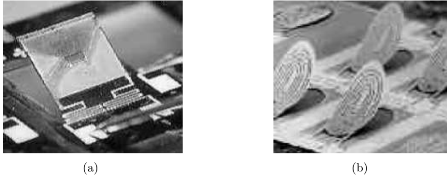
FIGURE 3.11 – Images MEB de micro-volets électromagnétiques [27] ; 4 \times 4\ \text{mm}^2
