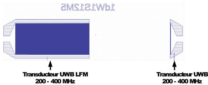
FIGURE 4.1 – Masque du dispositif SAW fonctionnant en transmission sur la bande passante 200 MHz – 400 MHz
