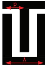
FIGURE 2.2 –  $\lambda$  la longueur d'onde et  $p$  la distance entre deux électrodes
