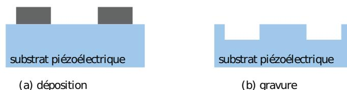
FIGURE 1.19 – Architectures des électrodes d'un réflecteur [19].
