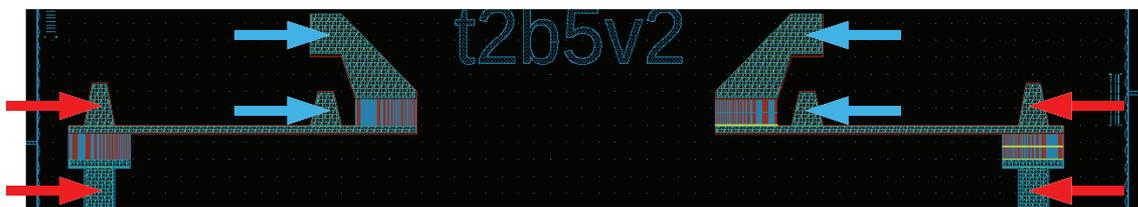
FIGURE 3.54 – Mesure des lignes séparément au testeur sous pointes
