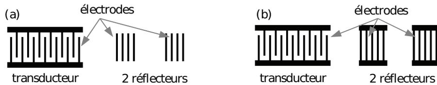
FIGURE 1.18 – (a) Dispositif SAW avec deux réflecteurs connectés en circuit ouvert, (b) dispositif SAW avec des réflecteurs connectés en circuit fermé.
