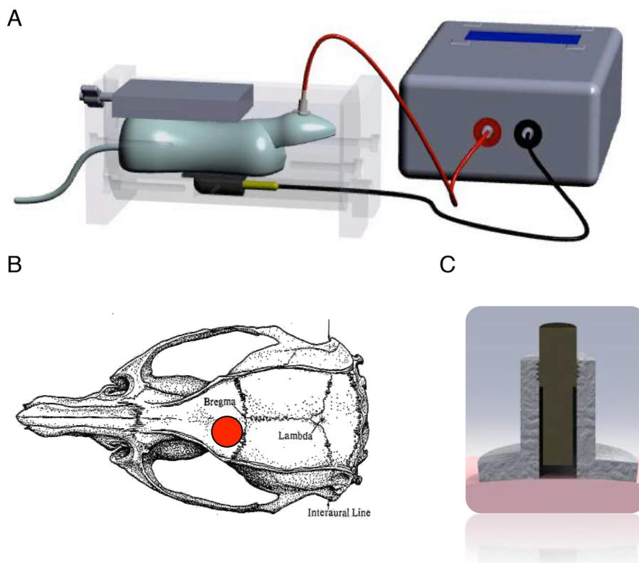
**Figure 31** Modèle animal de tDCS développé à l'EA481 (Pedron *et al*, 2014). A) L'animal est placé dans une boîte de contention, l'anode est positionné au niveau du cortex frontal, la cathode plaquée contre le thorax. B) Le centre de l'anode est placée 1 mm postérieurement et 1 mm vers la gauche par rapport au Bregma. C) Coupe montrant l'électrode vissée dans l'embase (embase en gris, remplie de liquide physiologique avant la stimulation).
