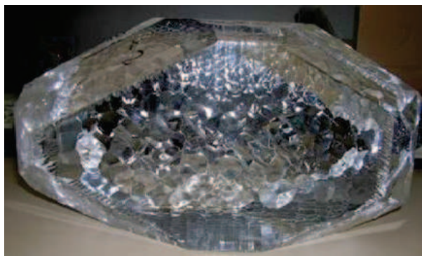
FIGURE 4.2 – Bloc de quartz pour wafers de 4” (longueur de 180 mm et hauteur sur germe > 80 mm avec au minimum 90 mm entre les faces Z)
