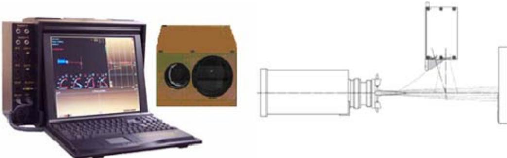
Figure 34 : Photo de l'accuraspray g3 de Tecnar Automation et schéma d'installation
