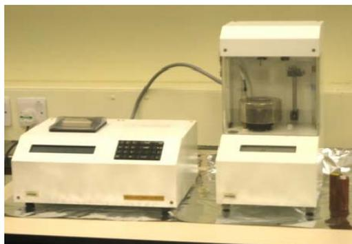
Figure 29 : Schéma de la méthode de Wilhelmy et photo du tensiomètre K12
