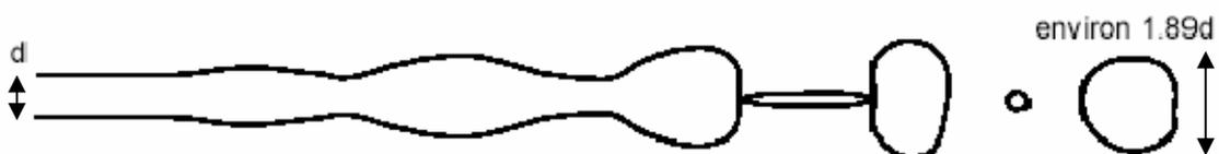
Figure 14: Schéma de la brisure de Rayleigh d'un jet [72]
