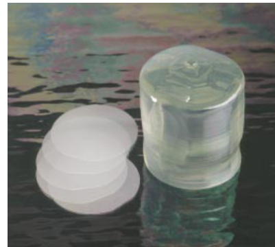
FIG. 2.5 – (a) Schéma de principe du procédé de croissance d'un cristal de Czochralski et (b) « carotte » de niobate de lithium (CrystalTechnologies) obtenue par cette technique [55]
