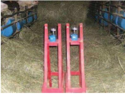
**Figure 6 : dispositif de prélèvement de poussière aéroportée**
