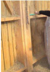
**Figure 8 : prélèvement de la poussière sédimentée à l'aide d'une spatule**
