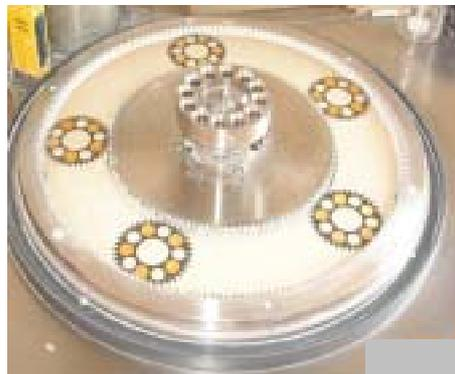
**Figure 8** : Satellites de la polisseuse double face et d'un porte-échantillon.
