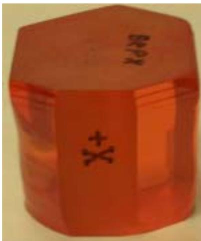
**Figure 2** : Lingot de Langasite (LGS) de type FOMOS obtenu par croissance Czochralski.
