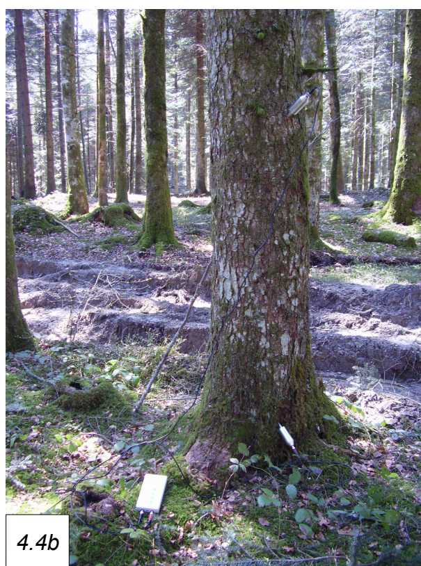
Figures 4.4a et 4.4b. Mesures radiale (a) et longitudinale (b) au Sylvatest Duo ® .
