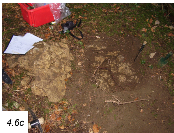
Figures 4.6a, 4.6b et 4.6c. Mesure de la pierrosité. Les éléments grossiers qui sont extraits de la fosse sont introduit dans le seau rempli d'eau. L'eau qui déborde est récupérée dans la bassine et son volume est mesuré.
