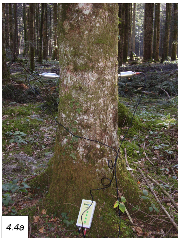
Figures 4.4a et 4.4b. Mesures radiale (a) et longitudinale (b) au Sylvatest Duo ® .
