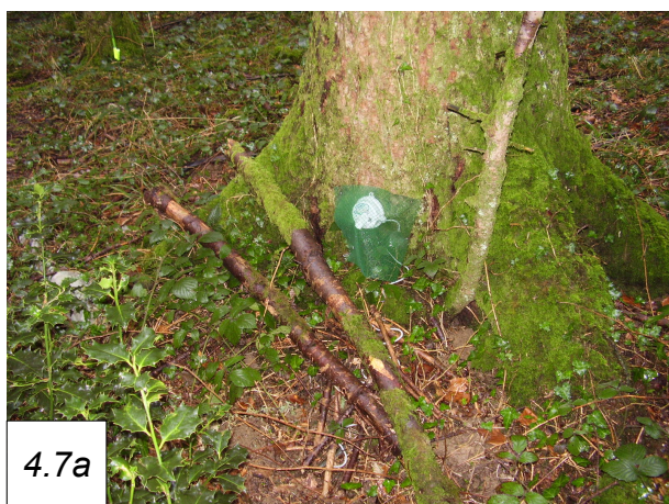
Figures 4.7a et 4.7b. Enregistreur de température Hobo® à sonde double (atmosphérique et sol). Il est fixé au pied du tronc de l'arbre puis dissimulé par un grillage en plastique souple. Le câble de la sonde externe est introduite dans le sol.
