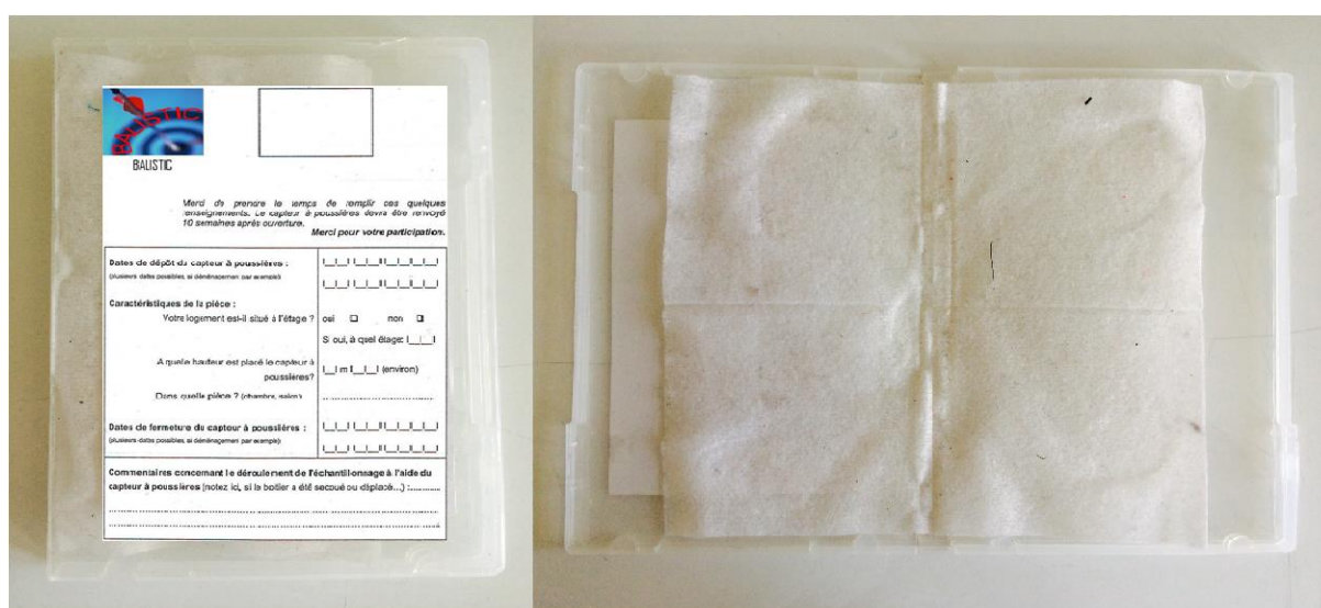
FIGURE 11 : CAPTEUR ELECTROSTATIQUE DE POUSSIERE (EDC).
