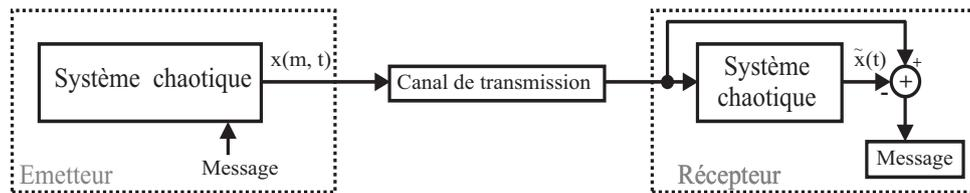
FIGURE 1.15 – *Principe de communication par modulation chaotique.*
