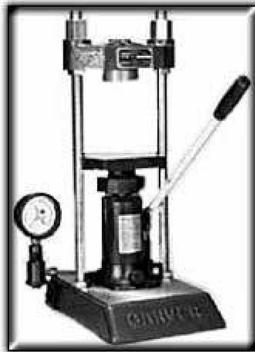
*Figure II.9: Système pour pressage uniaxial*
