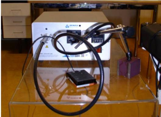
FIG. 6.25 – Photographie du système de collage à UV.
