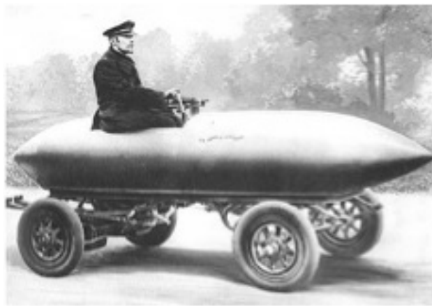
FIG. 17. La «Jamais contente» qui est la première voiture à passer les 100km/h - source Wikimedia Commons
