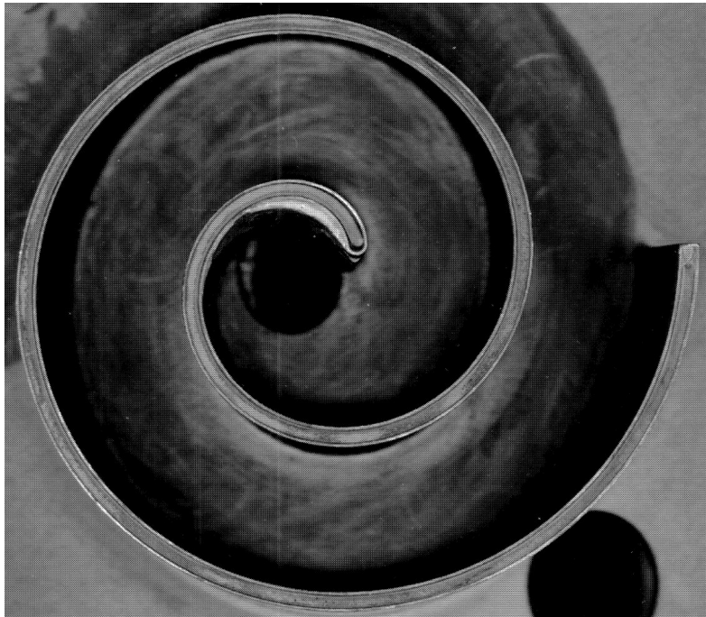
(a) Photo d'une spirale du compresseur scroll étudié
