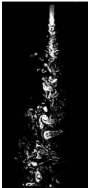
Figure n°21 : Jet d'eau turbulent, d'après Dimotakis, Lye et Papantoniou, 1981 in : Frisch, 2000)
