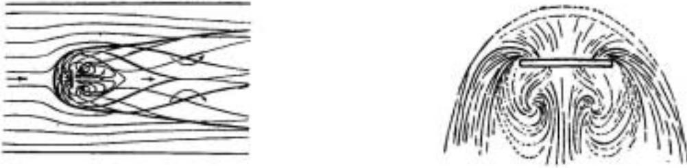
Figures n°11:L'eau courante rencontre une plaque. n°12 : Lignes de courant que l'eau a inscrites dans le ruisseau en contournant la plaque (l'amont est en haut)
