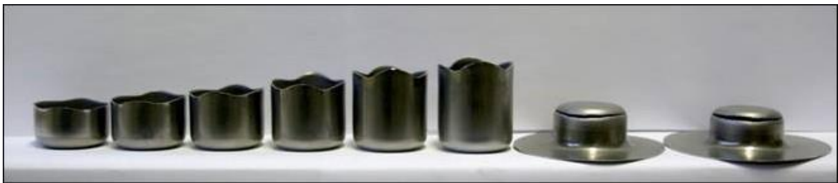
Figure 4.5 : (A) Evolution du coefficient de frottement moyen en fonction du nombre de cycles (B), godets obtenus par emboutissage d'acier inoxydable, lubrifié par C16P [ 5 \times 10^{-2} M]
