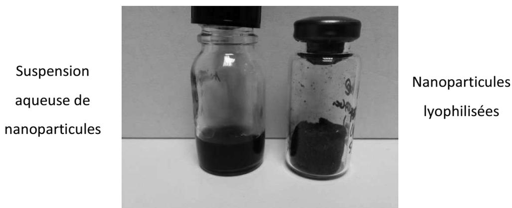
Figure 2.10 Photo d'une suspension aqueuse de nanoparticules et de nanoparticules lyophilisées
