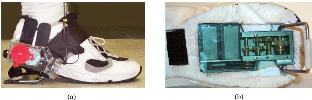
FIG. 1.10 – Chaussure électromagnétique [3] : (a) montage externe par lanière - (b) système intégré dans la semelle
