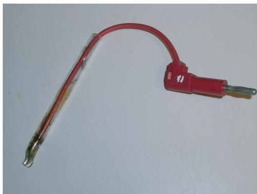
FIGURE 3.19 – Électrode en verre fabriquée au laboratoire.
