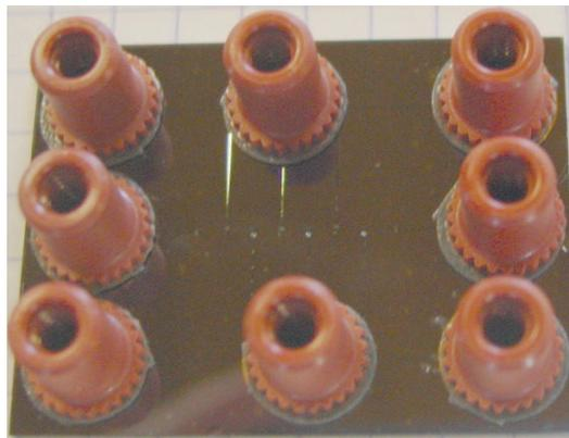
FIGURE 1.23 – Montage des connecteurs microfluidiques.
