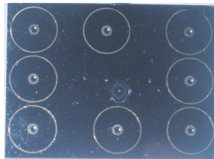
FIGURE 1.22 – Face inférieure après la soudure anodique.
