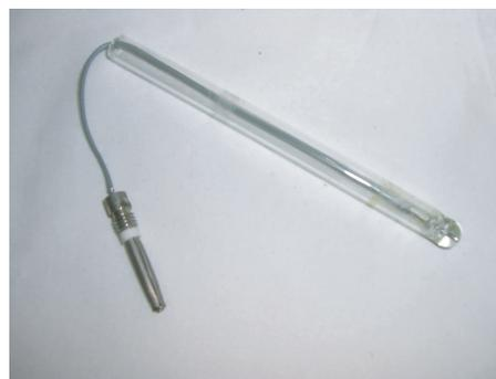
FIGURE 3.14 – Electrode millimétrique en verre.
