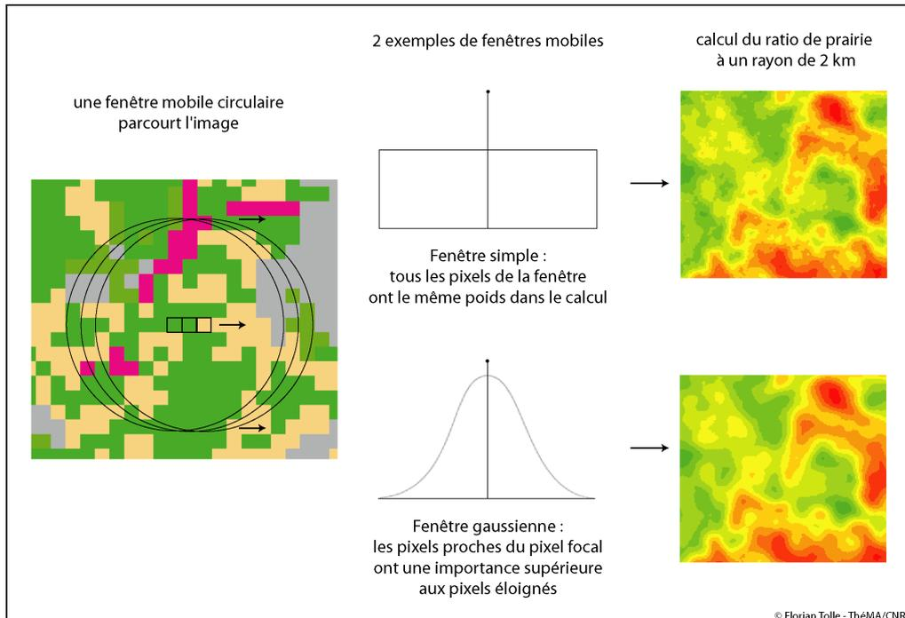
**Figure 40 : Le principe des fenêtres mobiles.**
