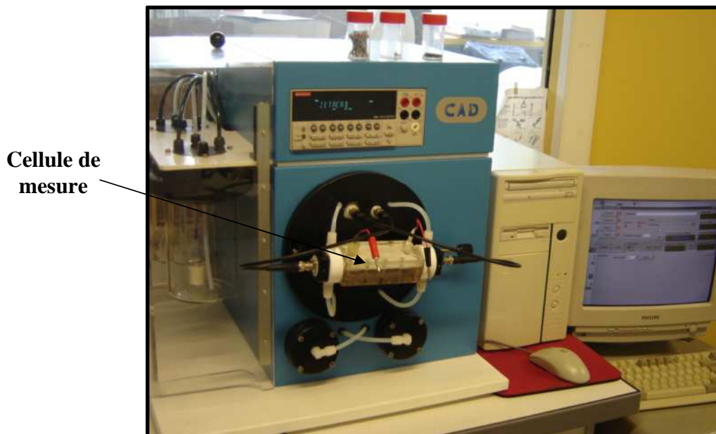
Figure 19 : Zêta-mètre ZêtaCAD permettant la mesure du potentiel d'écoulement tangentiel.
