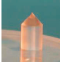
FIG. 2.13 – Axicon en verre BK7 utilisé pour la génération des faisceaux de Bessel.
