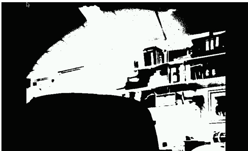
FIGURE 4.14 – Résultat de l’application d’un filtre de seuillage en temps-réel sur le flux issu d’un capteur vidéo.
