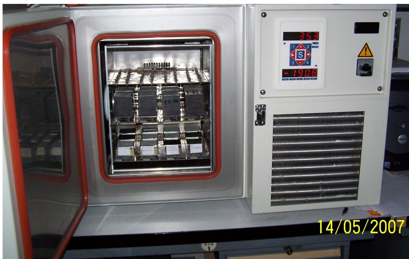
FIG. 5.8: Etuve thermique contenant les baies qui reçoivent les oscillateurs mannequins.
