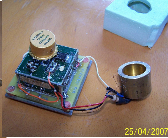
FIG. 5.11: Oscillateur mannequin OP22-M.
