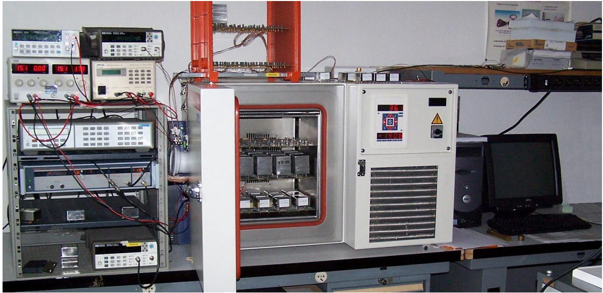
FIG. 5.9: Le banc de mesure de vieillissement.
