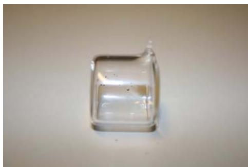
FIG. 3.1 – Cellule à vapeur de dimension centimétrique ( L=20 cm) avec le queusot.
