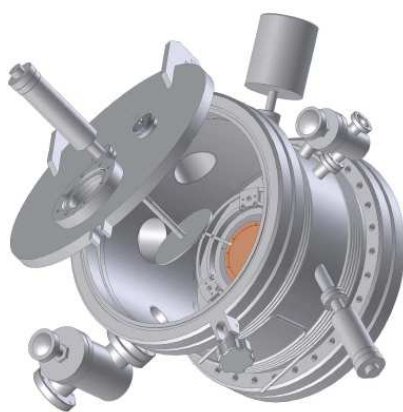
FIG. 3.25 – Nouvelle machine de soudure anodique en cours de fabrication.
