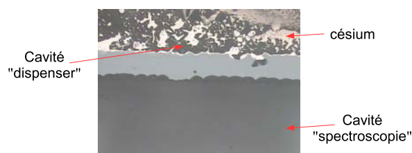
FIG. 3.27 – Dépôt des atomes de césium uniquement dans la cavité distributeur.
