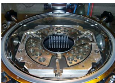
FIG. 3.17 – A gauche, l'enceinte de la soudure anodique , à droite, le collage hermétique réalisé entre le verre et le silicium de la microcellule.
