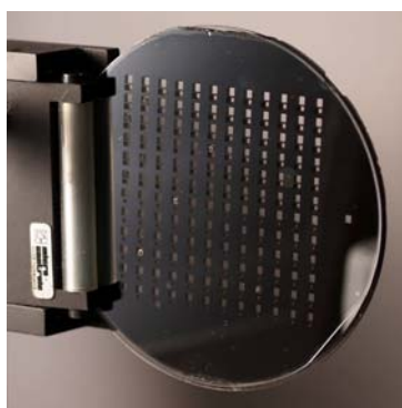
FIG. 3.14 – Les 144 microcellules réalisées dans un substrat.
