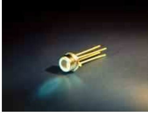
FIG. 4.7 – Photo d’une diode laser VCSEL AVALON-Photonics dans un boîtier TO46
