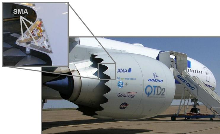
FIG. 1.11 – Chevron à géométrie variable de Boeing, test en vol (J.H. Mabe (2006))
