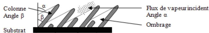
Figure 1.6 : Phénomène d'ombrage avec compétition de croissance des colonnes sous un flux de vapeur incident [15].
