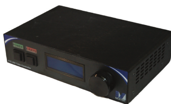
FIGURE 2.4 – Boîtier de contrôle : MOXTEK FTC-200 Controller.
