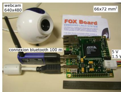
FIG. 3.6 – La carte Fox, une Webcam Logitech et un dongle Bluetooth
