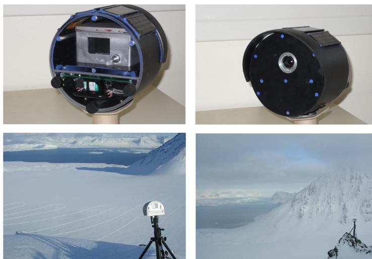
FIG. 2.22 – Capteurs déployés au Spitsberg équipés d'appareils photo numérique
