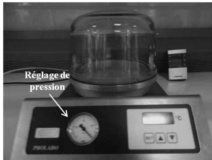
FIGURE 2.30 – Enceinte à vide utilisée dans le procédé de préparation du PDMS.
