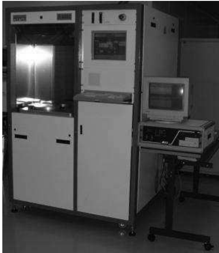
FIGURE 2.6 – Appareil de gravure Alcatel disponible à la salle blanche MIMENTO de FEMTO-ST.
