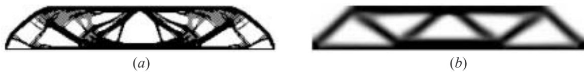
Figure 2-40. Problème de la poutre MBB - Solutions par la méthode SIMP (a) sans filtre (b) avec filtre.
