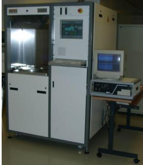
Figure 5—9 : Bâti de gravure profonde par plasma (DRIE Alcatel).
