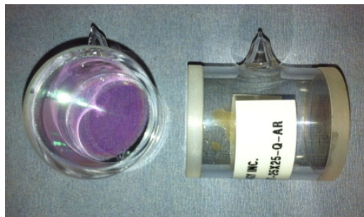
Figure 3.16 – Photographie représentant deux des cellules utilisées. Les cellules proviennent de Triad Technologies Inc.. La partie violette est le traitement anti-reflet.
