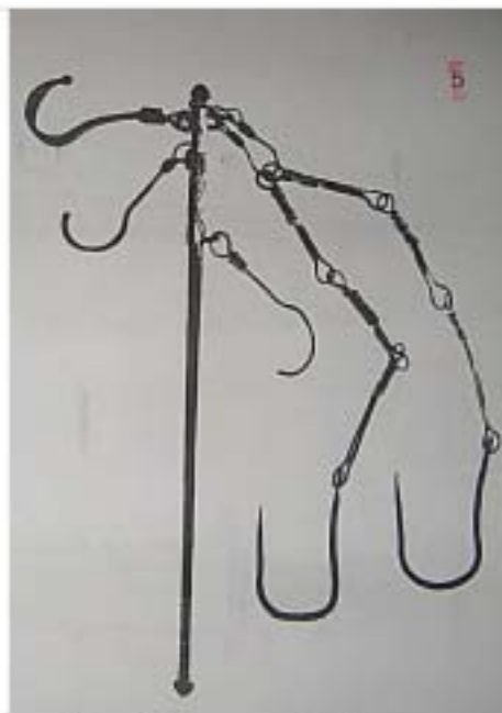
Figure 1 : balance romaine, bronze ou cuivre (longueur du fléau 275 mm) (3 rivières 1980, n°16) (PCN n°2 de Pontoux)
