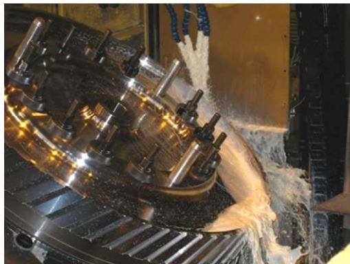
Figure 4 : Fluide de coupe projeté sur une pièce métallique en cours d'usinage. (Source : J.B. Murat©).
