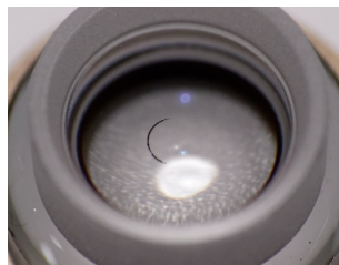
FIGURE 5.3 – Groupe arrière d'un objectif de microscope \times 20 endommagé : une portion d'anneau est gravée à la surface de la première lentille du groupe (demi-cercle noir) et rend l'objectif inutilisable.
