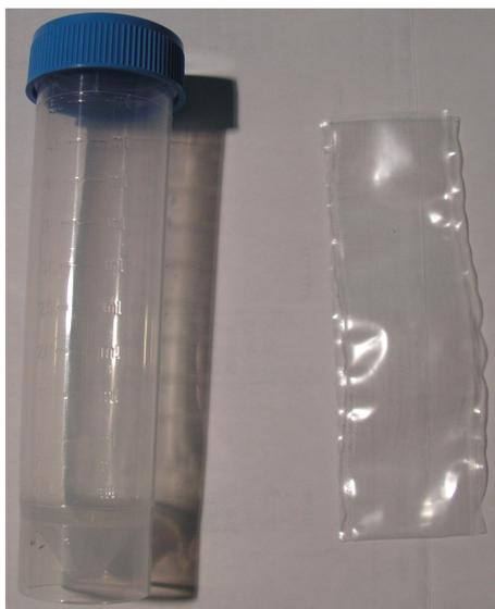
**FIGURE 3.11** – Sachet de 50  $\mu\text{m}$  et tube de 50 mL dans lequel est placé le sachet, préalablement rempli de 2 mL d'eau tritiée à  $1853 \text{ Ci.L}^{-1}$  et soudé thermiquement. Le tube est ensuite rempli avec 50 mL d'eau ultra-pure
