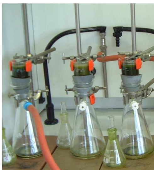
Figure 6-F : Photographie de la filtration sous vide sur creuset filtrant du mélange eau, méthanol, chloroforme (1/2/2: v/v/v).
