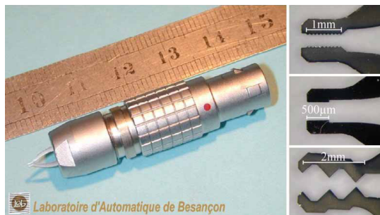
FIGURE 1.2 – Microprehsensile Microrobot On Chip (MMOC) et organes effecteurs en Nickel [Agn05].
