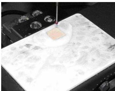
FIGURE 5.2 – Plateau givrant en fonctionnement.
