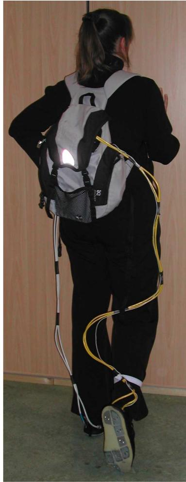
FIG. 2.2 – Photo du prototype initial produit par Faivre (2003) : deux chaussons équipés chacun de huit capteurs reliés à un système d’acquisition placé sur le dos du sujet.
