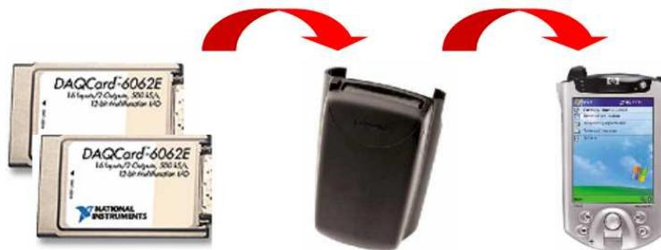
FIG. 3.8 – Matériel d'acquisition : deux cartes PCMCIA, un double port de carte PCMCIA et un PDA.
