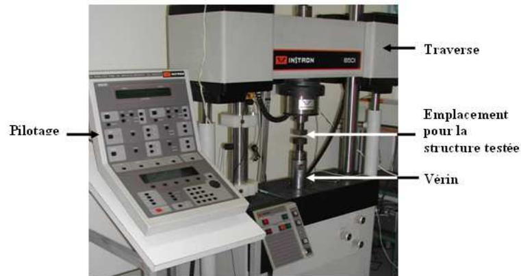
FIG. 2.16 – Machine de traction permettant les tests mécaniques sur les capteurs.
