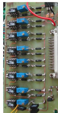
FIG. 2.5 – Schéma du montage en quart de pont de Wheatstone incluant une jauge de déformation de type CEA-06-125UN-350 et photo du conditionneur pour les huit jauges d'un chausson.
