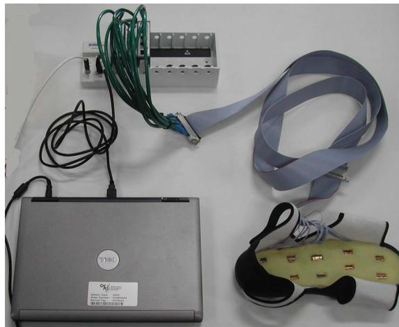
FIG. 3.17 – Ensemble du système embarqué par le patient : chausson équipé de 11 capteurs reliés au conditionneur National Instrument ®, lui même connecté à l'ordinateur d'acquisition des données.
