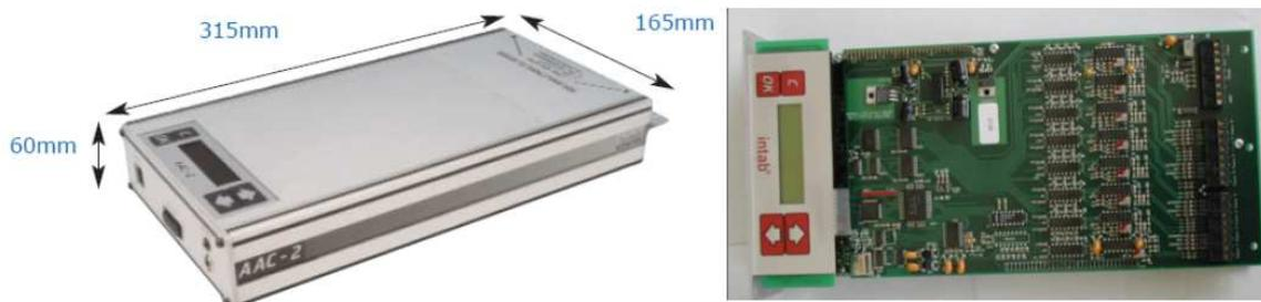
FIG. 2.6 – Dimensions et intérieur d'un boîtier INTAB PC LOGGER ®.
