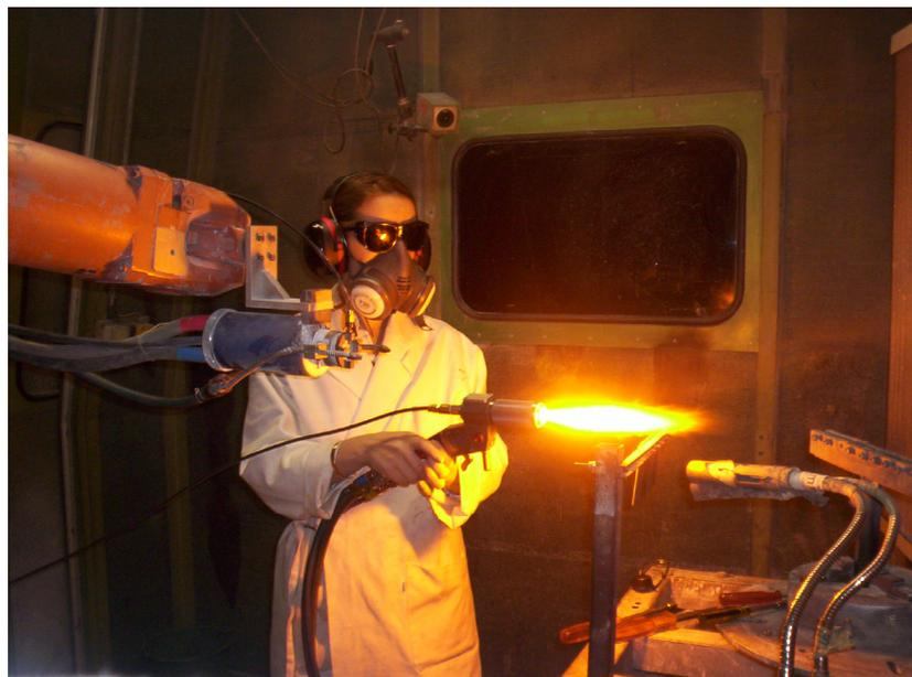
**Figure II.13** : Projection thermique par flamme de la sous-couche d'alumine.
