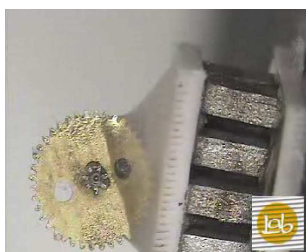
FIGURE 3.15 – Maintien d'un engrenage de montre par une goutte d'eau gelée par effet Peltier.
