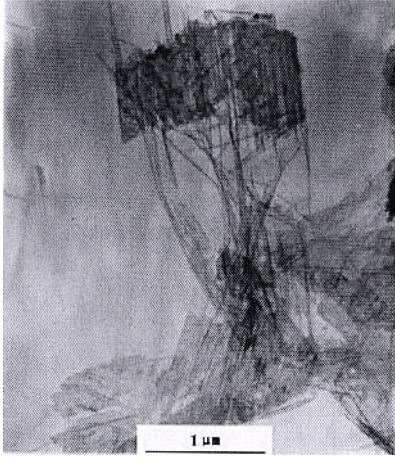
Figure IV-4 : Image MET de todorokites synthétiques. On observe des fibres étendues à partir d'une structure centrale ayant conservé la morphologie de la birnessite précurseur formée de plaquettes de fibres enchevêtrées (d'après Feng et al., 2004).
