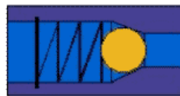
Position fermée due à l'augmentation de la température
