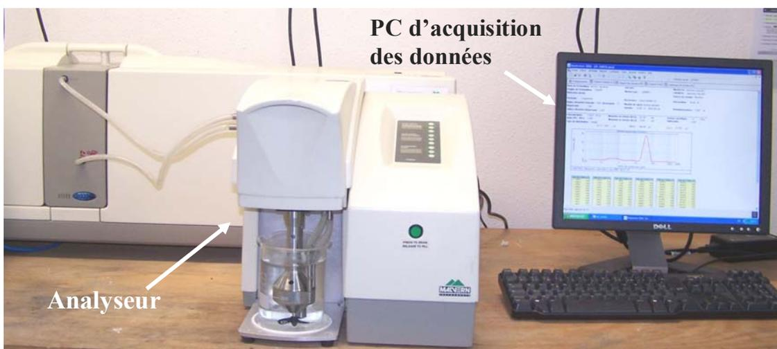
Figure 11 : Analyseur Coulter LS130.
