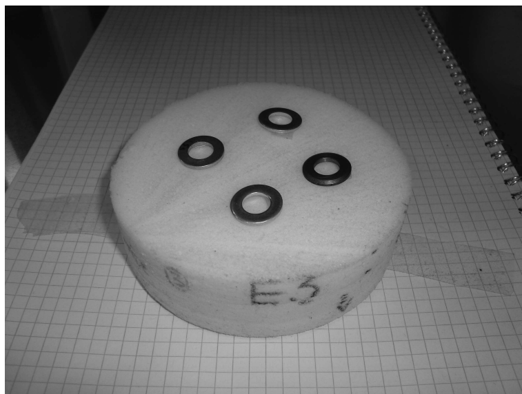
FIG. 3.15: Vue de la découpe de l'échantillon de mousse avec masselottes
